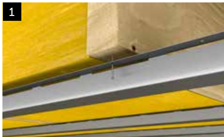
1 Profilen fästs i bjälkens underkant med skruv i det förborrade hålet eller högst 25 mm därifrån. Detta så att profilen inte förlorar den fjädrande effekten.
