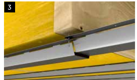
3 Skarvning sker över stöd med profilerna kant i kant och de båda förborrade hålen rakt över varandra.
