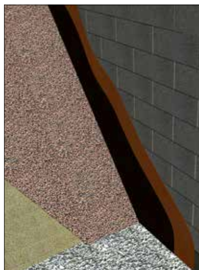
Bild 5.5. Källarvägg med LECA lättklinker
