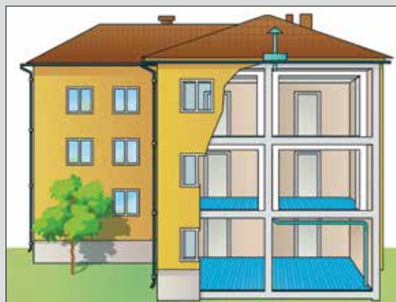
3. Sammankoppling till befintlig frånluftsventilation
